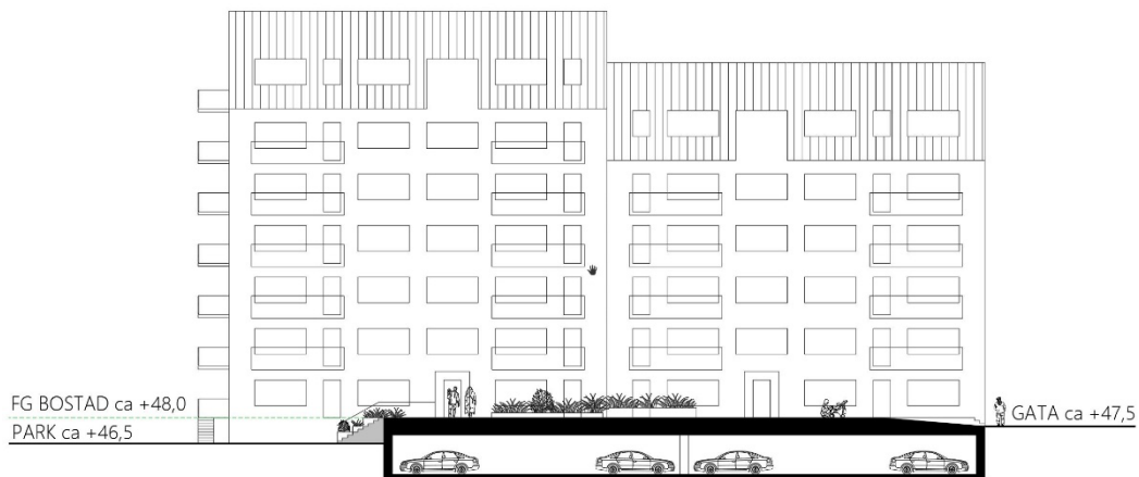
Figur 72 Principsektion genom kvarter i norra delen av planområdet. Redovisar hur byggnader förhåller sig till gata respektive säker nivå avseende Vänerns vattenstånd.
