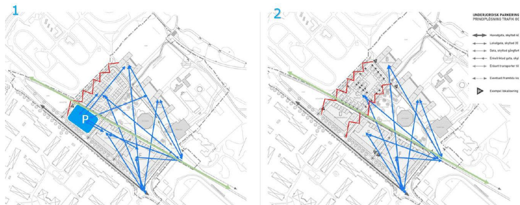
Figur 75 Gång- och cykelrörelser samt risk för otrygga stråk i området för Scenario 1 respektive Scenario 2. 1 representerar scenario med p-hus medan 2 är scenario med underjordisk parkering inom respektive fastighet (Ramboll, 2023).
