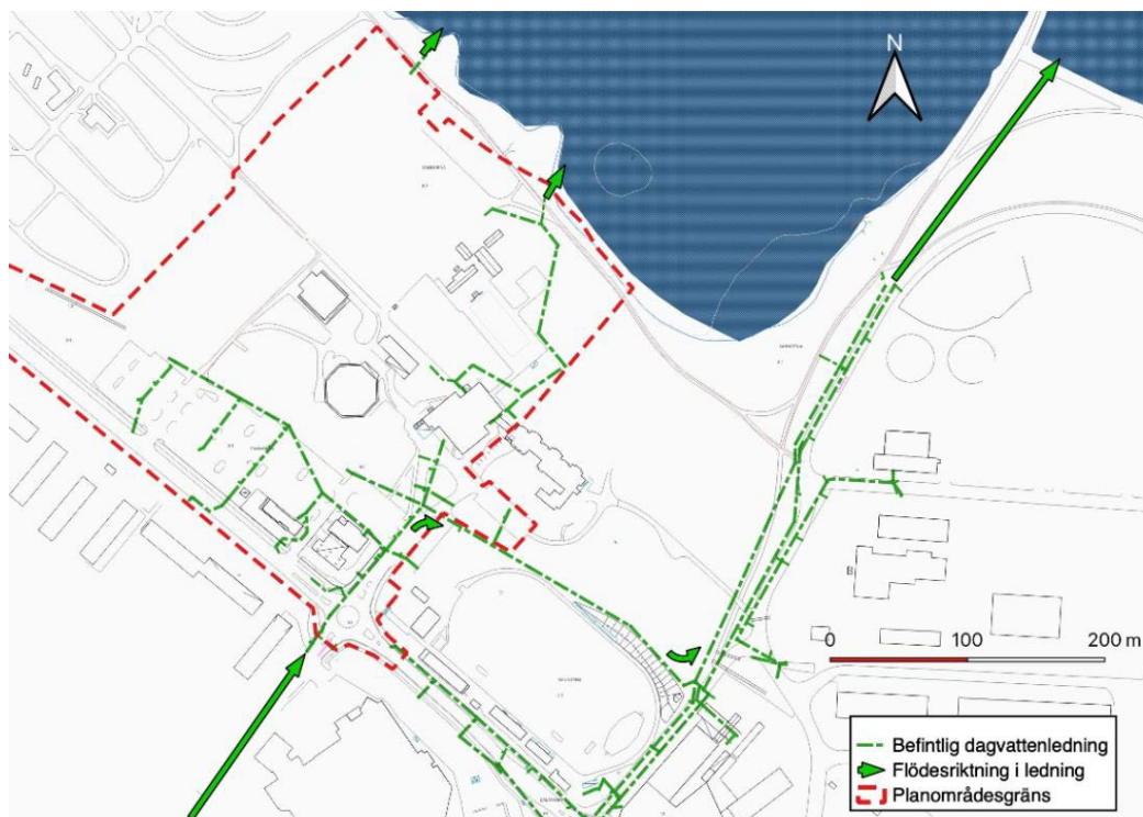
Figur 28 Befintlig avledning av dagvatten från planområdet (Melica, 2023)
